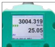
**Opción:** medición bi-direccional. La flecha azul o verde en la display muestra la dirección del flujo. Para cada dirección de flujo dispone de un contador.
