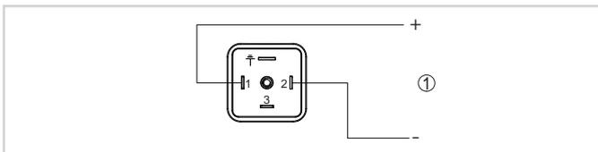
Esquema de conexiones - dos hilos 4 ... 20 mA - conector según ISO 4400
