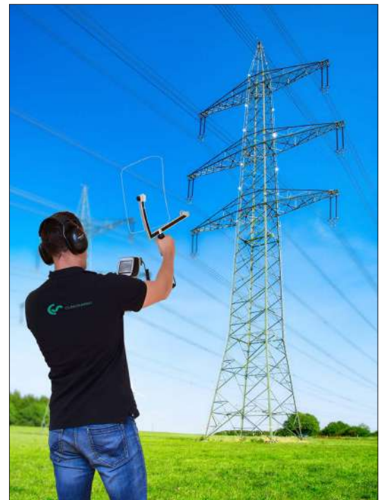
Revisión de descarga en corona en líneas libres de alta tensión
