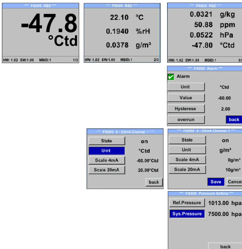
La display integrada muestra el punto de rocío en grande y las demás magnitudes de humedad en otras 2 ventanas de la display. Con la flecha se puede cambiar de una ventana a otra.
