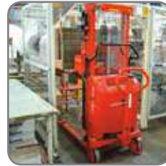
Gran maniobrabilidad: Poca altura de construcción, gran ángulo de giro de las ruedas directrices, dirección asistida y bajo peso de la propia máquina.
