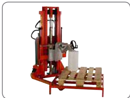
El soporte porta palets permite acceder a las bobinas desde cualquier posición.
