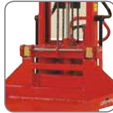
El cambio rápido facilita el reemplazar la plataforma por otro tipo de implemento u horquillas
