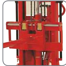
El cambio rápido facilita el reemplazar el espolón por otro tipo de implemento u horquillas.
