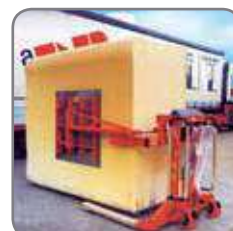
Logiflex de patas ajustables, con pinza de apriete para manipular bloques de espuma.
