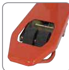
Con las ruedas de carga gemelas es muy fácil cambiar de dirección.
