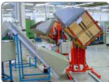
Logiflex con tablero rotativo, para elevar y vaciar componentes en una línea de producción.
