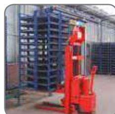
Logiflex automatizado, controlado desde un ordenador central, para la puesta a disposición de pallets vacíos en la línea de producción.
