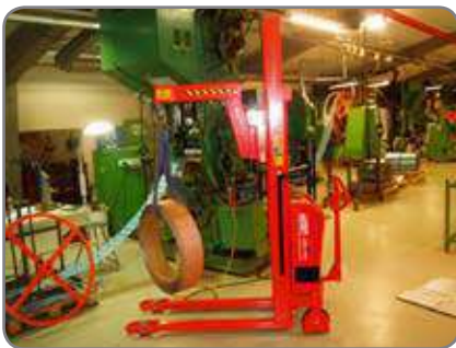
Brazo grúa trabajando en la industria de componentes.
