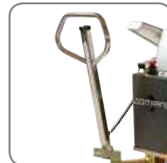
El timón puede ladearse completamente.
