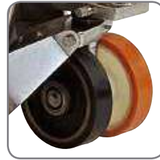
Las transpaletas tienen al menos una rueda anti-estática de vulcolán para derivar la electricidad estática del equipo.
