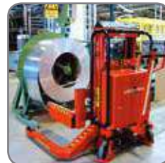
Logiflex con horquillas especiales para el transporte y apilado de bobinas pesadas y de gran diámetro.
