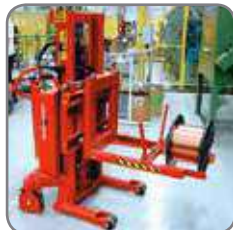
Logiflex con carro de eje pasador y horquillas especiales montadas sobre un desplazador lateral.
