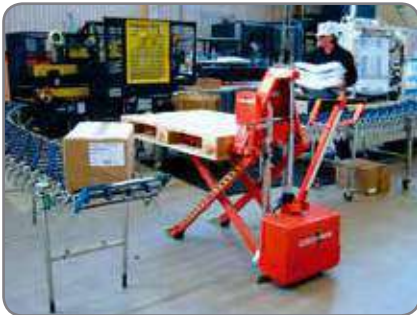
Altura de fotocélula ajustable. En transpaletas de tijera: entre 490 y 970 mm; y en apiladores: entre 550 y 920 mm.
